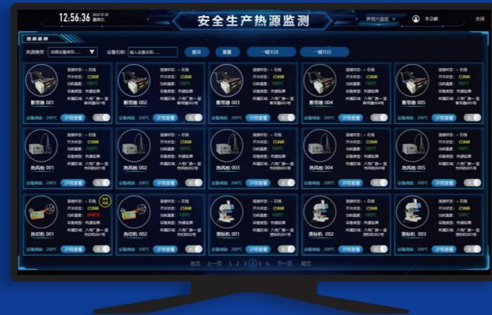
热源监测子系统通过对厂区使用的断带器、热风枪、热切机、烫标机等设备温度数据进行实时监测，实时掌握设备的工作状态和安全情况。
