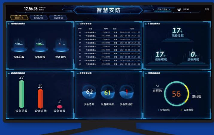
安防管理子系统对视频、门禁、广播、巡更、对讲等安防系统的状态进行采集，从而实现对报警、异常设备的快速发现、快速响应，确保安防设施好用、管用、能用。
