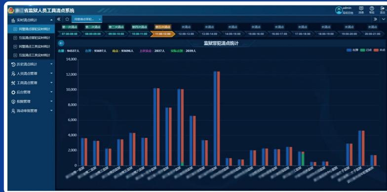
监狱人员工具清点系统是将关押罪犯及劳动工具的信息通过条形码（或RFID）一一对应，并通过人脸识别、手持终端等智能化方式实现清点，确保人员及工具在管控范围，保障监管安全。
