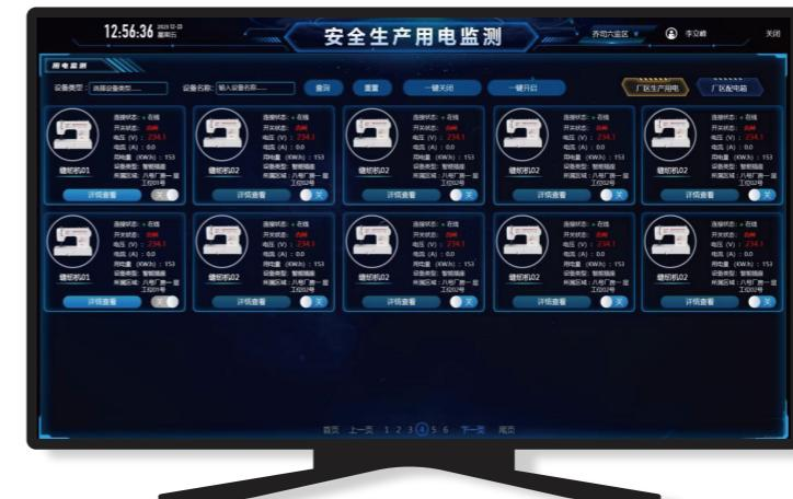
智慧用电子系统是安全生产的基础，也是监狱安全生产监管体系的核心组成部分。系统主要对生产过程中各类电气指标、安全指标进行实时监控，将无形的电气火灾隐患可视化、数字化，实现监狱劳动厂区用电管理智能化、数据监测全面化、安全控制策略化，为监狱安全生产及生产效率提供有力保障。
