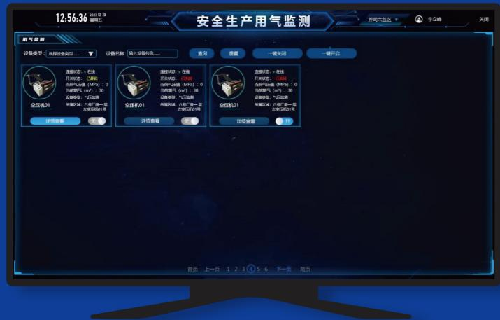
用气监测子系统通过对厂区使用的空压机的气压数据进行实时监测，实时掌握空压机的工作状态和安全情况。
